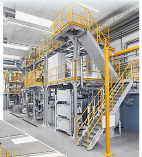
Oben: Komplett verrohrt und verkabelt liefert Krauss Maffei Berstorff die unterschiedlichen Module aus
